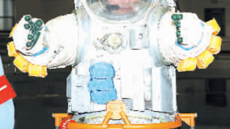
「飛天」是中國完全自主知識產權的第一代艙外航天服。整體設計和各部件的設計、組裝都是中國人自己完成。圖為翟志剛活動水下訓練服關節。
